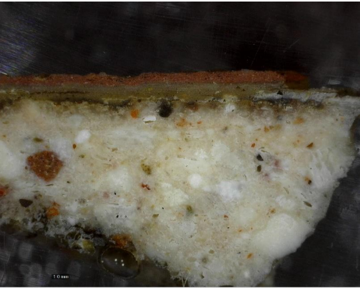
ზემოთ: სინჯის ანათალი, პორტატული მიკროსკოპით გადაღებული ფოტო, 50x გადიდება
