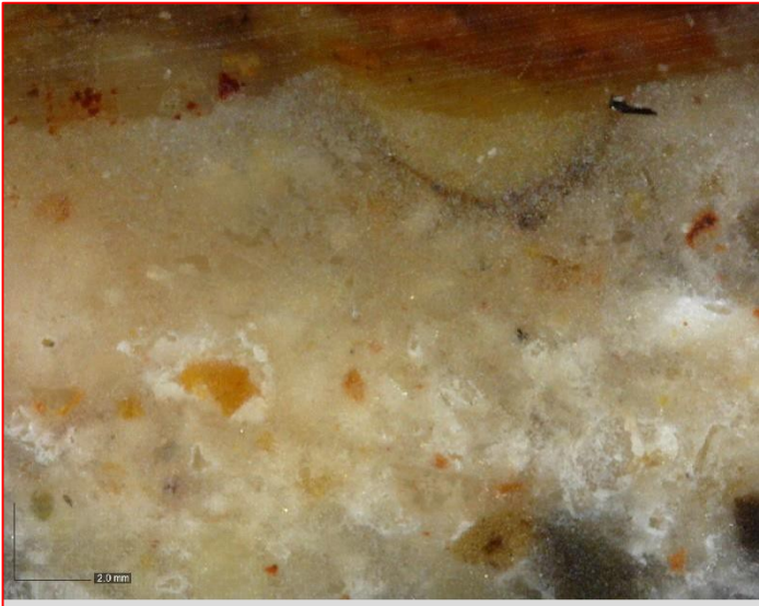
ზემოთ: სინჯის ანათალი, პორტატული მიკროსკოპით გადაღებული ფოტო, 200x გადიდება
