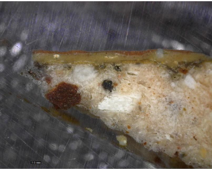
ზემოთ: სინჯის ანათალი, პორტატული მიკროსკოპით გადაღებული ფოტო, 50x გადიდება
